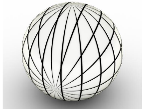
Netwerk van twee stel meridianen maar met het tweede stel meridianen verschoven
